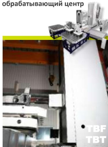
Обрабатывающий центр Для обработки колес
